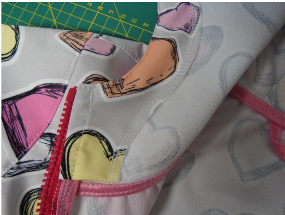
60. A kapuci prošijeme v jehelním šití overlocku po celé její délce
