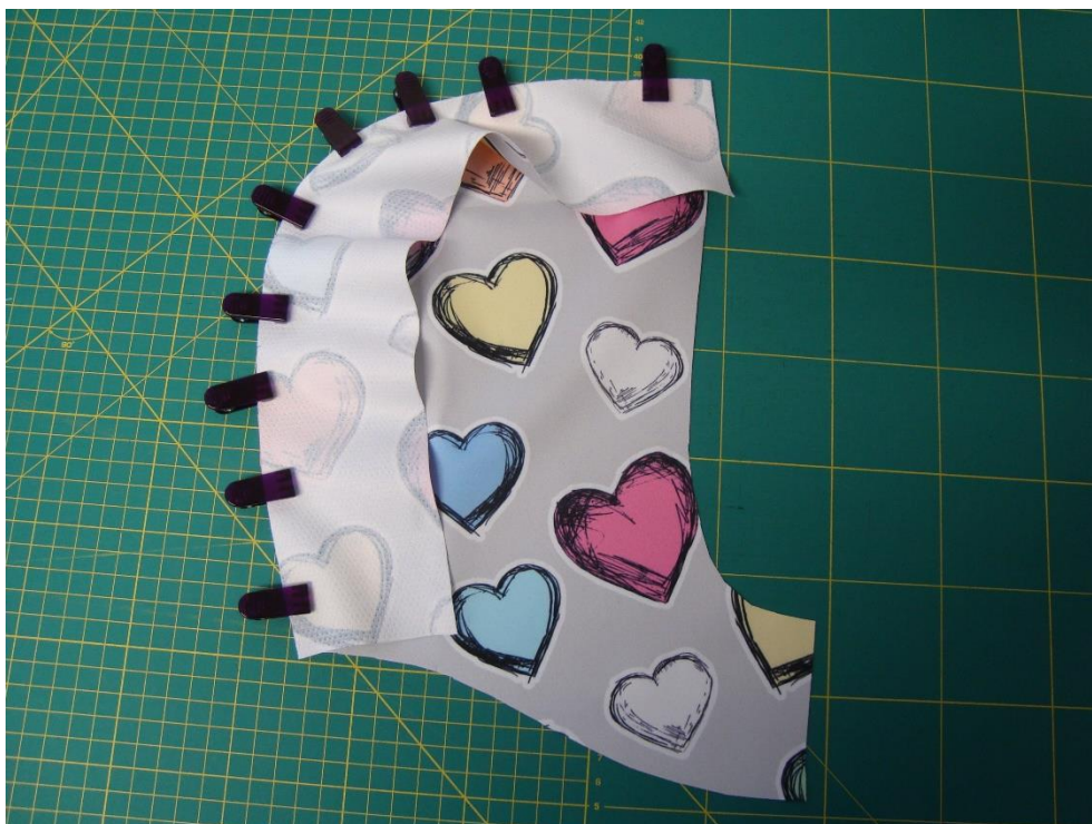
14. Střední část kapuce si našpendlíme na boční část kapuce
