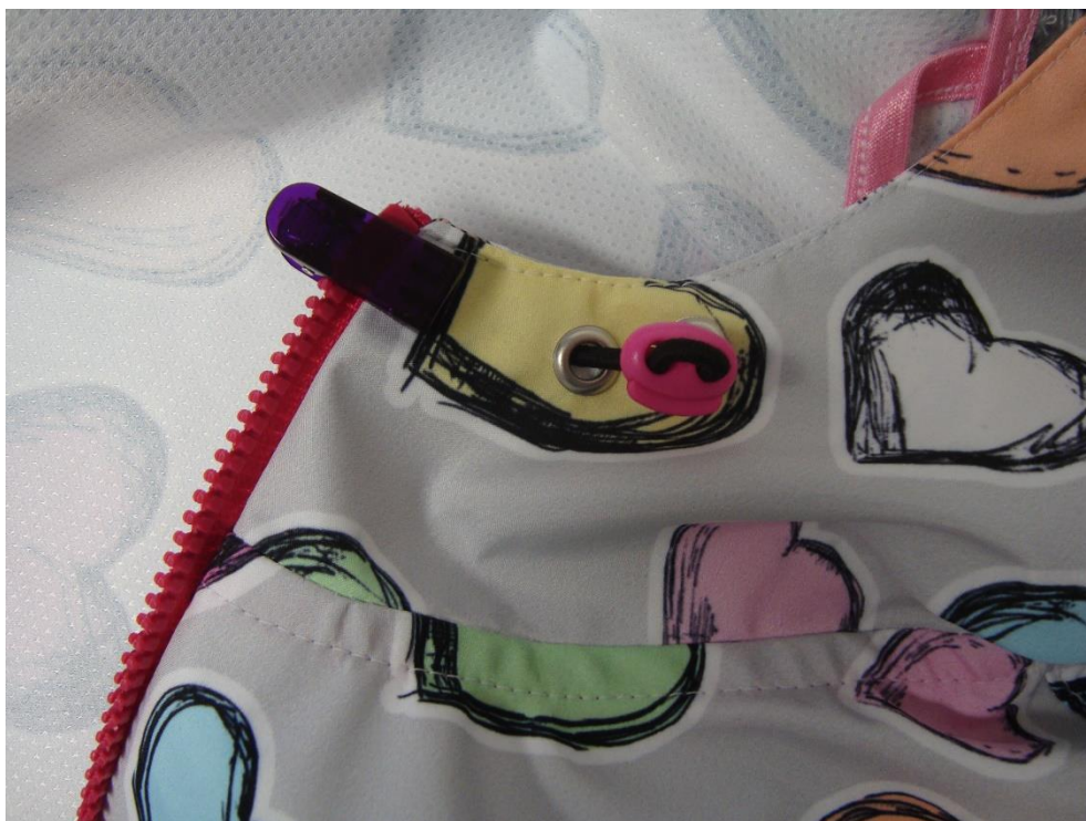
54. Vsuneme do průchodky a opět u švu našití zipu zajistíme svorkou
