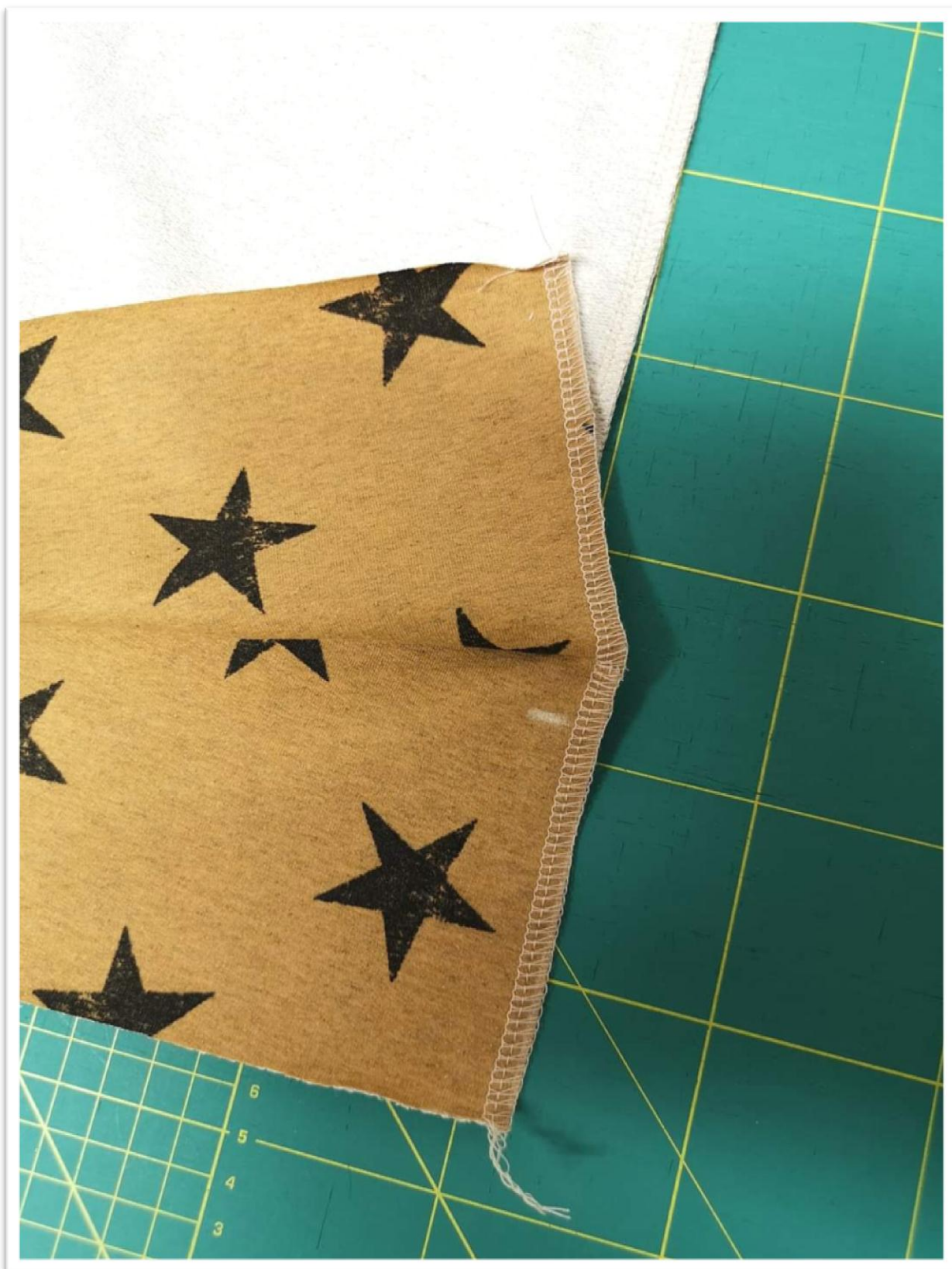
11. Detail začištění. Začišťujeme tak obě strany najednou.
