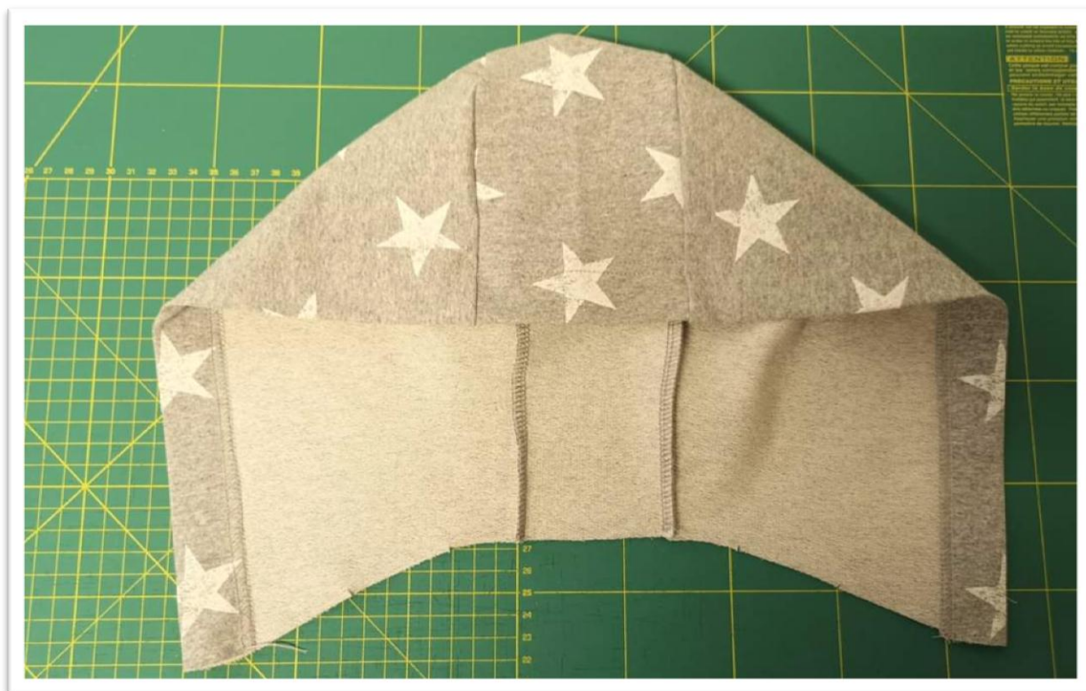
19. A prošijeme na coverlocku, dvoj Jehlou či nějakým overlockovým stehem.
