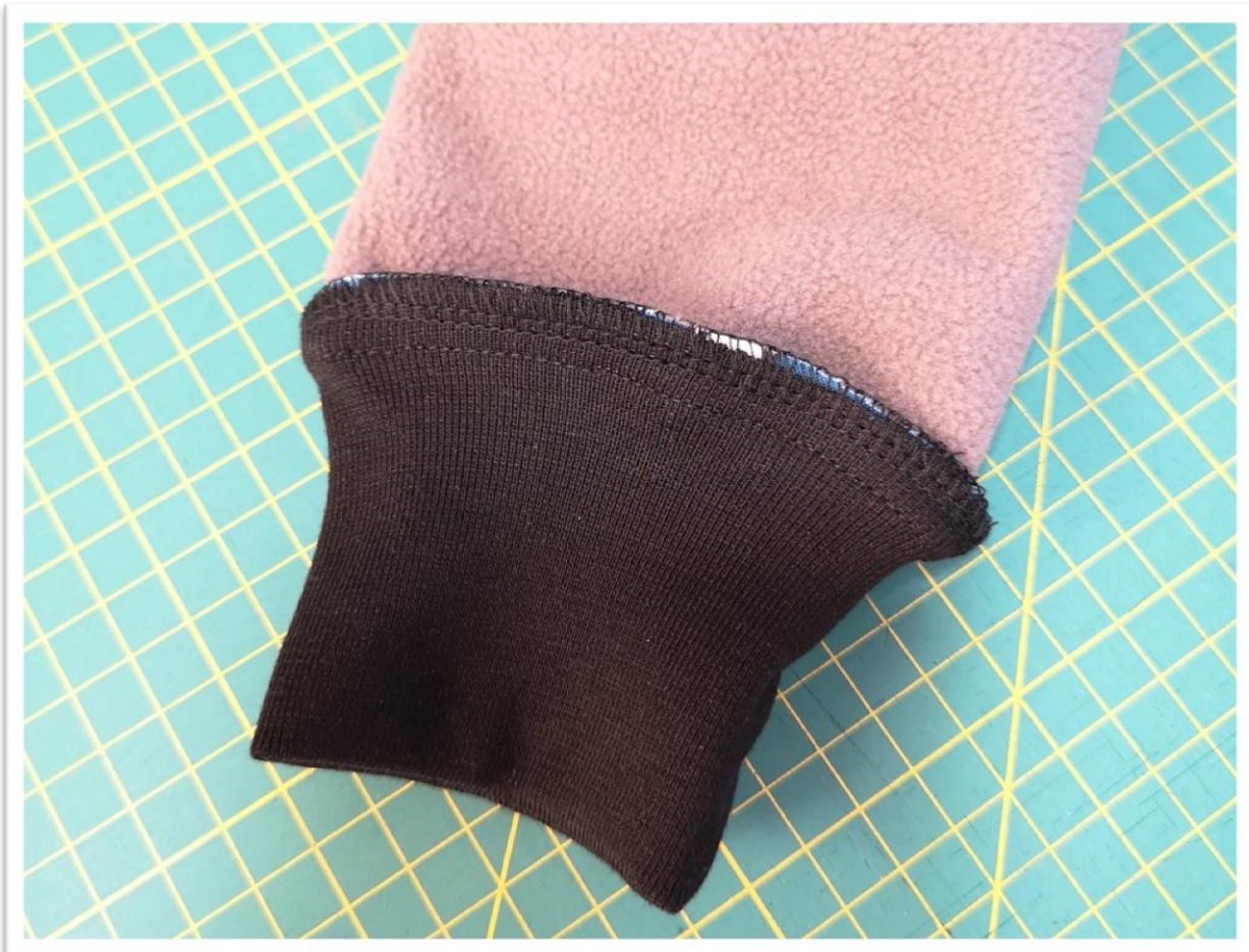
95. Šev začistíme overlockem.
