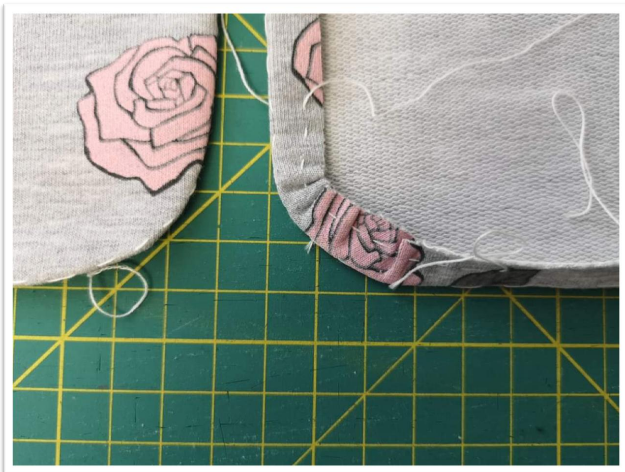
37. V obloučích si pomůžeme stažením nití z nastehování.
