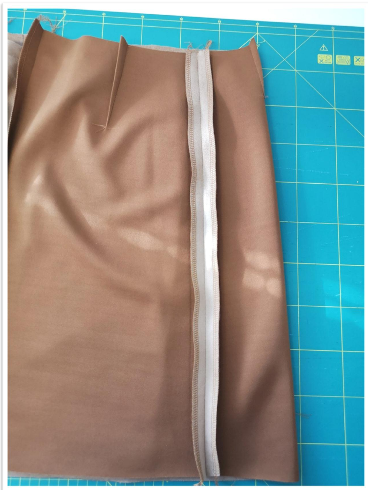
33. Boční švy začistíme na overlocku a rozžehlíme.
